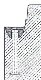
Application en sous face de coffrage
